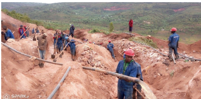
Processus de lavage des minéraux par les écluses
